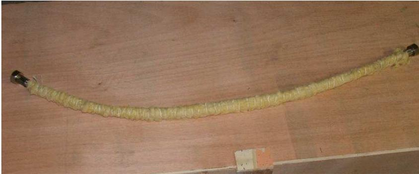
Le même flexible isolé laine de verre introduit dans une gaine type Armaflex.
